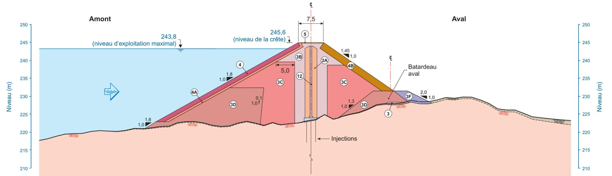
Digue à noyau de béton bitumineux (digue B2) – Coupe A
